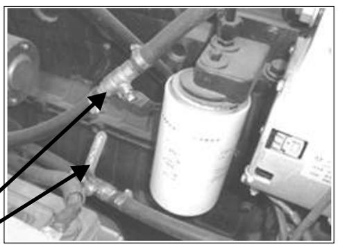
Interruptores de aire acondicionado en el costado del motor posee una llave de paso para el sistema de calefacción o aire acondicionado
