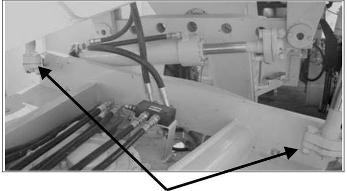
Soporte de los vástagos del cilindro de elevación (engrasar)
