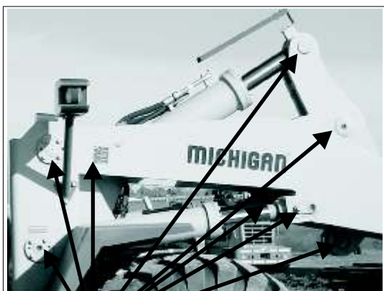
Articulación del cucharón y cojinetes del cilindro cargador. Engrase (2puntos)
