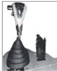
1- Tire la palanca de control completamente para atrás para activar el freno de estacionamiento.
