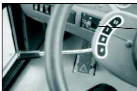
Panel de control de calefacción
