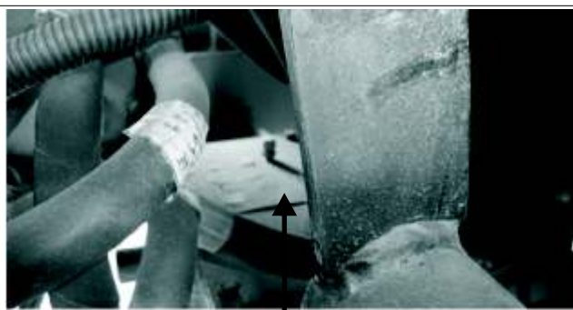
Respiraderos de la caja de transmisión
